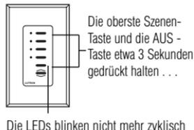
Das Kommunikationsverbindung ist eingerichtet. Die Steuerstelle empfängt Daten, wenn eine Taste der Bedienstelle gedrückt wird. Wiederholen Sie diesen Vorgang für alle andere Bedienstellen, um die gewünschte Kommunikation einzustellen.
