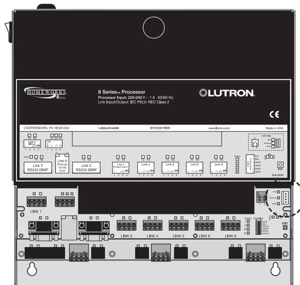
Processore con modulo interfaccia compreso
